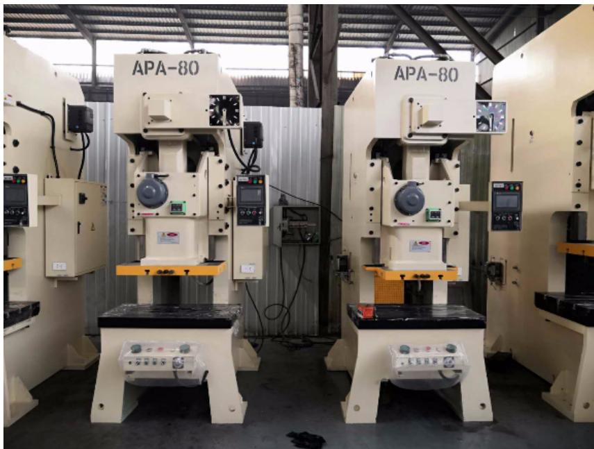
高速冲床选用自动送料机给料, 并配置磨具, 料架, 冲压模具等组成的一条自动化流水线。为了实现金属材料冲压模具制造行业的要求, 我厂会生产制造出愈来愈多的高速高精密冲床。伴随着销售市场的发展趋势, 计算机的发展, 速率化变化的发展趋势, 现高速冲床转为更高速、高效率、全自动、高精密、专属型及多种类的生产制造方位迈入。高速冲床按冲次分成小高速和高速, 冲次每分三百次上下的, 业界称为小高速。超过五百次的, 称为高速。操作高速冲床过程要穿紧身的防护衣, 衣袖卡紧, 上衣外套衣摆不可以拉开, 禁止戴胶手套, 不可在启动的设备旁穿、脱换衣, 或围布于的身上, 避免设备绞伤!
