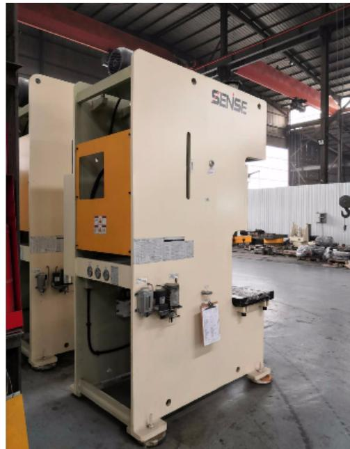
冲床连杆和滑块之间需有圆周运动和直线运动的转接点，其设计上大致有两种机构，一种为球型，一种为销型（圆柱型），经由这个机构将圆周运动转换成滑块的直线运动。冲床对材料施以压力，使其塑性变形，而得到所要求的形状与精度，因此必须配合一组模具（分上模与下模），将材料置于其间，由机器施加压力，使其变形，加工时施加于材料之力所造成之反作用力，由冲床机械本体所吸收。冲床普遍应用于电子、通讯、电脑、家用电器、家具、交通工具、（汽车、摩托车、自行车）五金零部件等冲压及成型！
